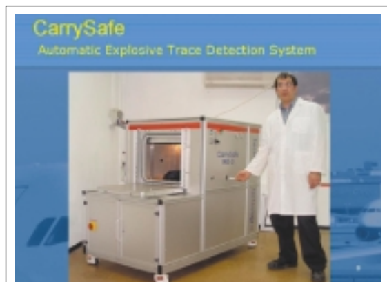
Das automatische System «Carry Safe» von TraceGuard zur Erkennung von Sprengstoffspuren kann in Gepäckkontrollgeräte integriert werden, wie sie bereits in den Flughäfen bestehen.
